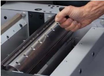
**工具がなくても1/10mmの精度でセット出来るカッターブロックシステムが標準装備!**
